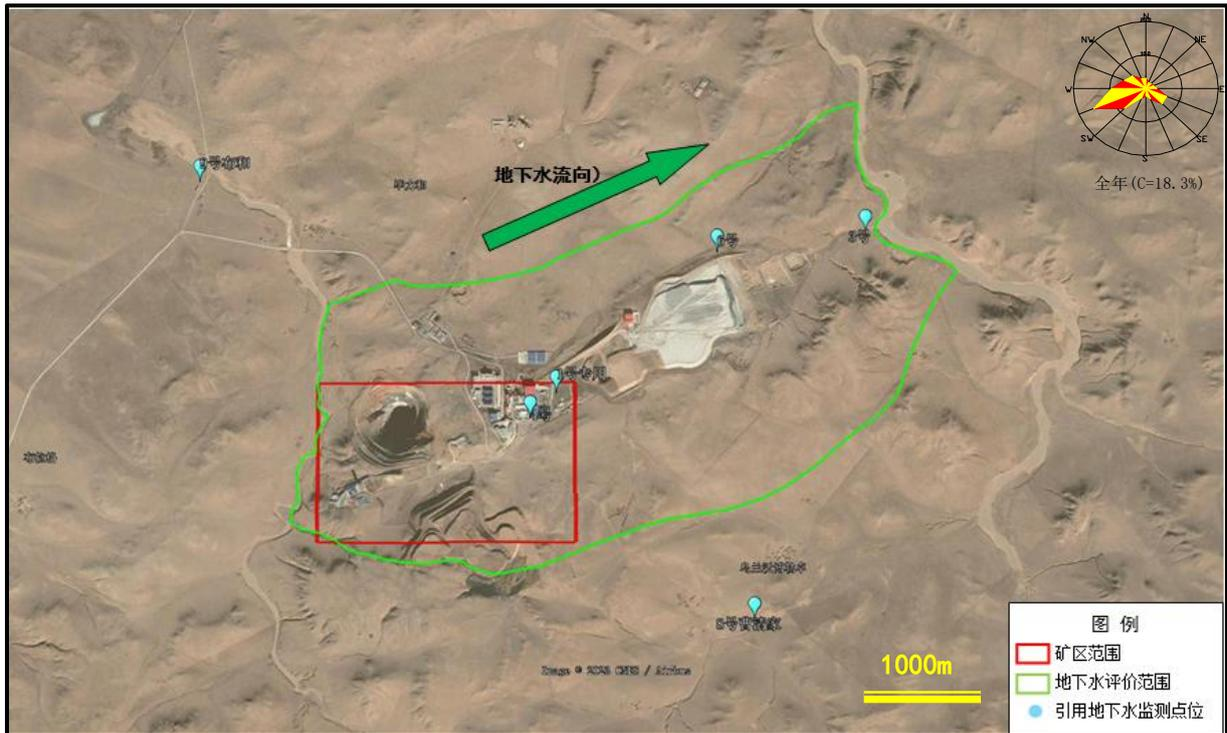
图 4.5-1 地下水监测点位示意图
